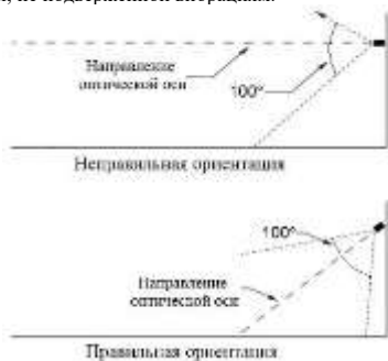
Рисунок 5 – Установка извещателя по отношению к горизонту
